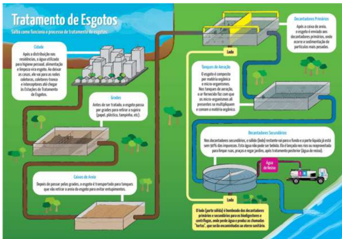
Figura 6: Esquema do tratamento de esgoto.
