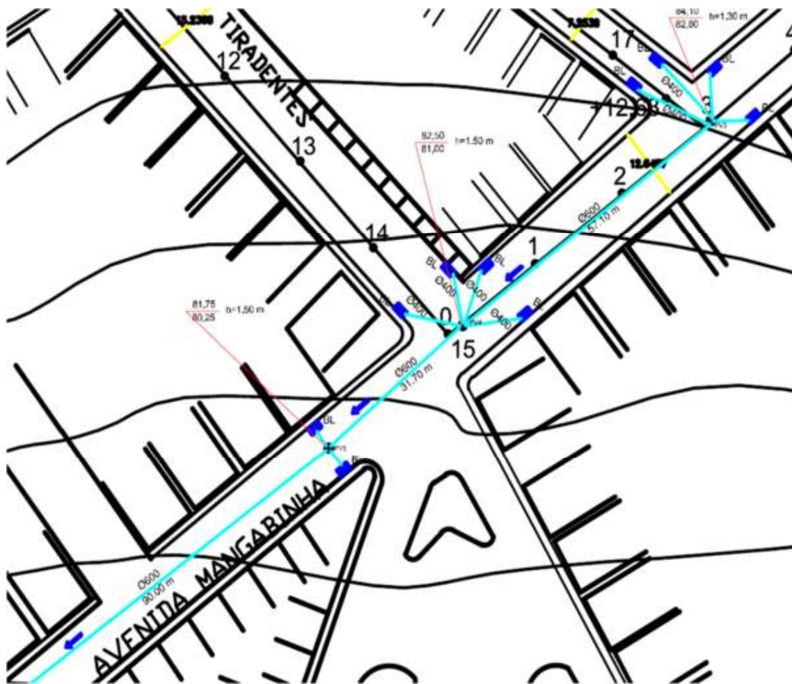
Figura 31: Traçado da rede de drenagem, com a dimensão e comprimento da mesma. Fonte: SEMURB (2021).
